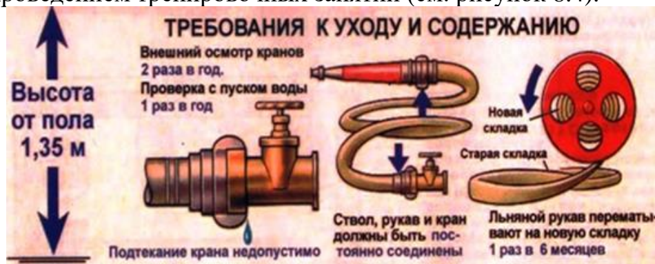
Рисунок 8.4 – Требования к уходу и содержанию внутреннего пожарного крана
