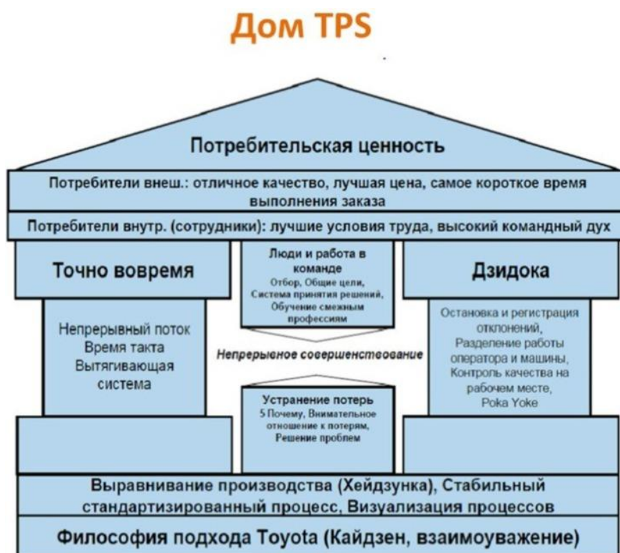
Рисунок 5.2 - Схема «Дом TPS» (инструменты и принципы)
