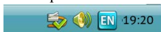
Рисунок 4. Доступ к графической утилите «Сетевые соединения» из области уведомлений рабочего стола Fly
