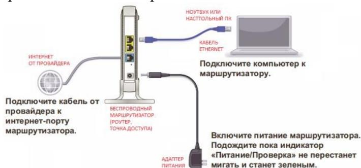
Рисунок 13 - Схема подключения устройств беспроводной сети к точке доступа
