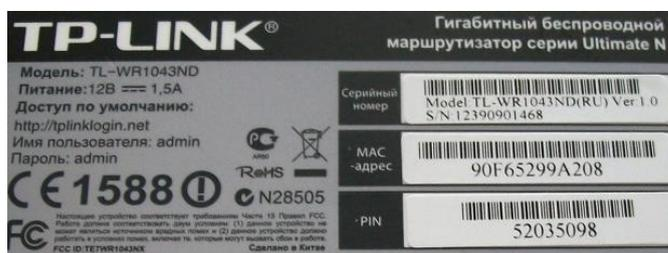
Рисунок 6 - На этикетке маршрутизатора читаем PIN-код
