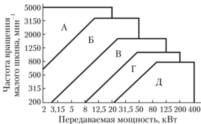
Рисунок 16.1 - График выбора типа ремня
