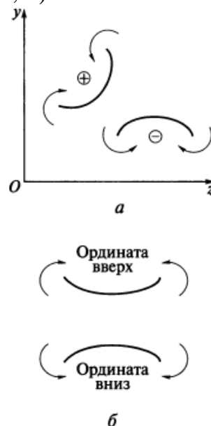
Рисунок 14.5 - Схема определения знаков для изгибающего момента
