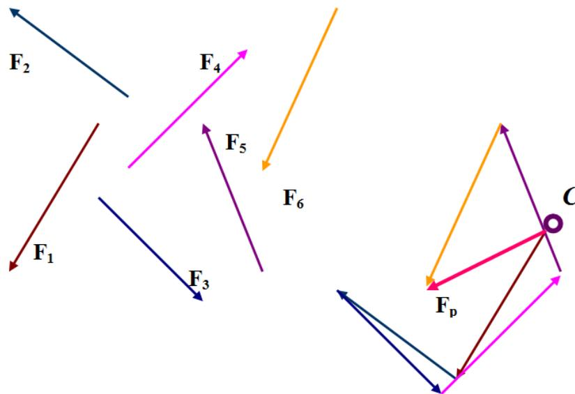
Рисунок 3 - Плоская система произвольно расположенных сил
