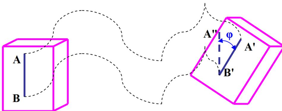
Рисунок 16 - Плоскопараллельное движение твердого тела
