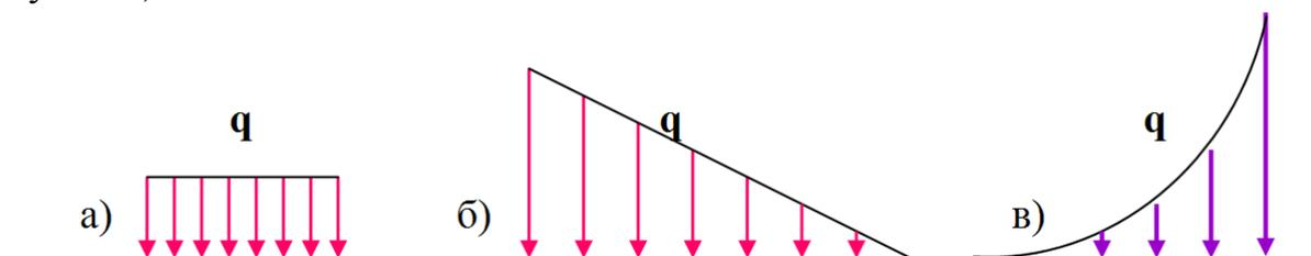
Рисунок 4 - Виды интенсивности нагрузки по длине
