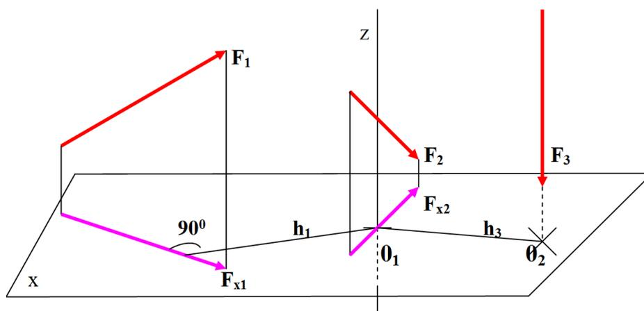
Рисунок 10 - Момент силы относительно оси.
