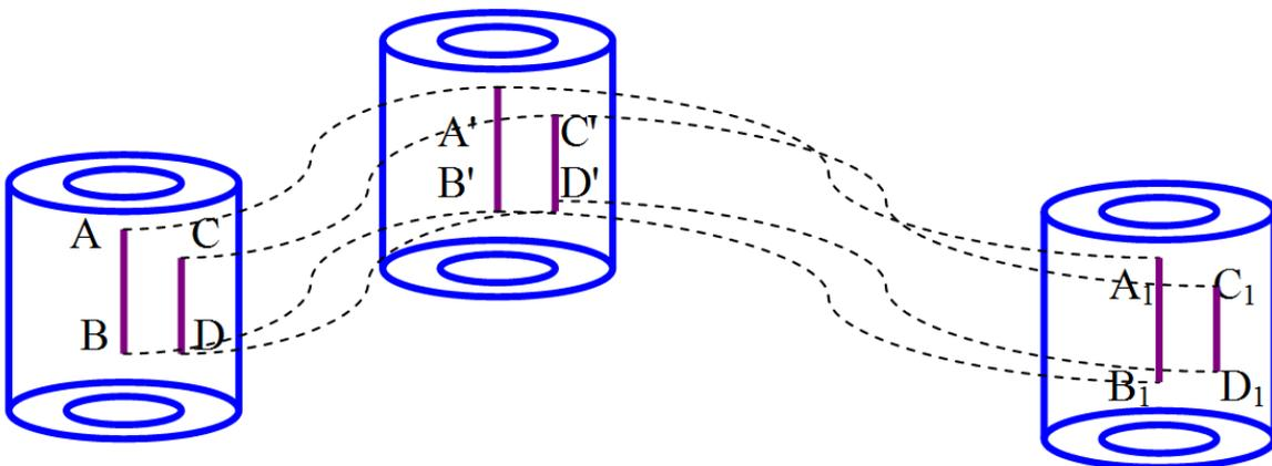
Рисунок 12 - Поступательное движение твердого тела
